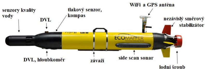
Obr. 4. – Hardwarové rozložení aparatury EcoMapper AUV.
