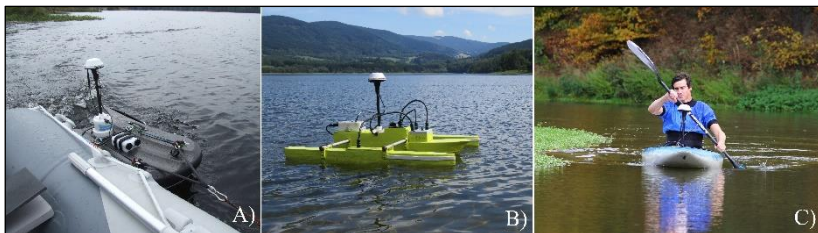
Obr. 3. – Nosná plavidla testované měřicí aparatury RiverSurveyor M9.
