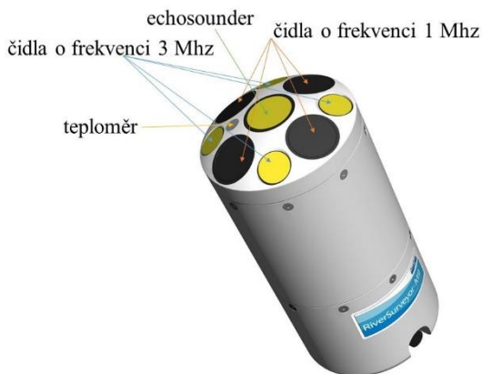
Obr. 2. - Rozložení čidel na sonaru RiverSurveyor M9.
