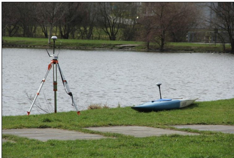
Obr. 7 – Připevnění a stabilizace měřicí aparatury RiverSurveyor M9 na kajaku
