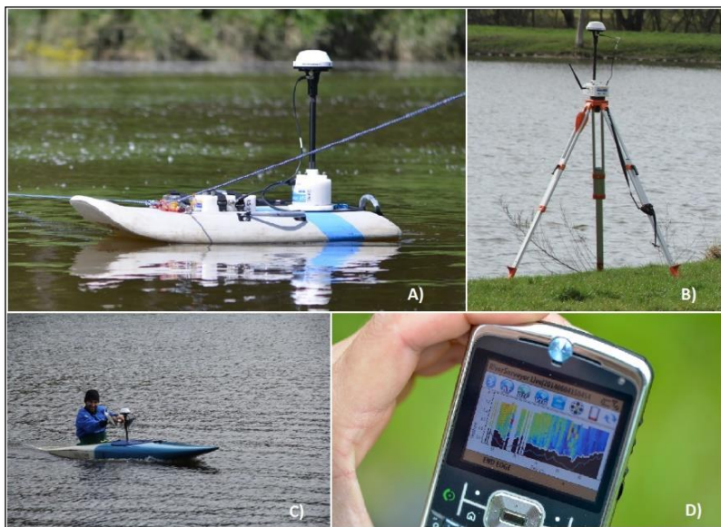
Obr. 2 – Součásti a využití měřicí aparatury: A) Použití měřicí aparatury Riversurveyor M9 při měření průtoku a příčnéhoprofilu říčního koryta. B) Referenční stanice – stativ + RTK base station. C) Prezentované použití měřicí aparatury Riversurveyor M9 při batymetrickém měření na vodní nádrži. D) Uživatelské rozhraní softwaru RiverSurveyor Live for mobile – ovládání v reálném čase.
