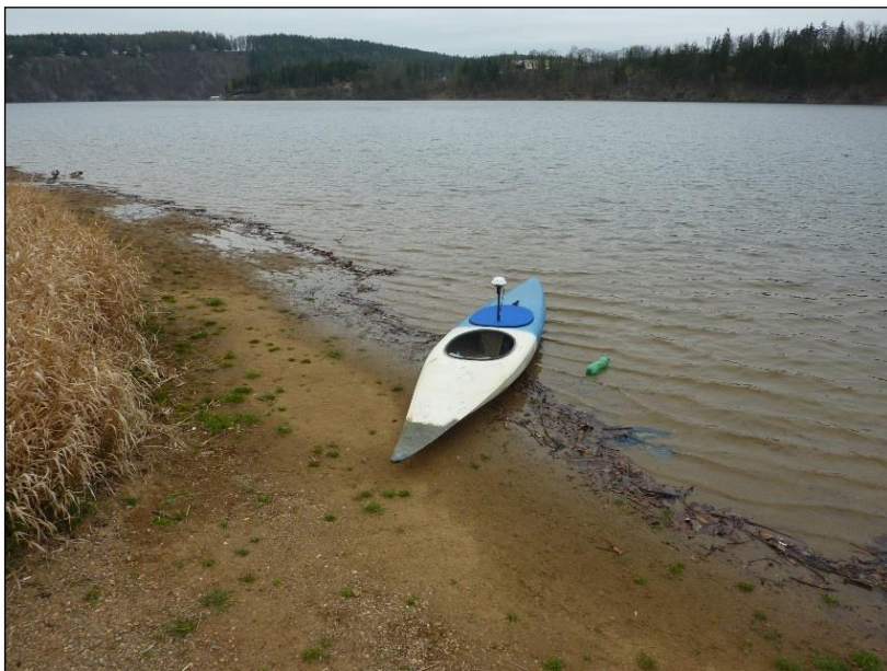
Obr. 4 – Nosné plavidlo z přestavěné závodní debl kánoe.
