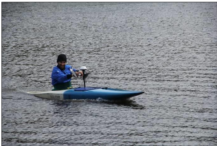
Obr. 8 – Připevnění a stabilizace měřicí aparatury RiverSurveyor M9 na kajaku
