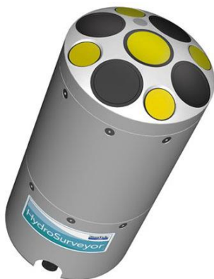
Obr. 1 – Acoustic Doppler current Profiler (HydroSurveyor.) – měřicí hlavice/sonda Průměr 128,4 mm. Postranní, žluté senzory o frekvenci 1 Mhz. Černé senzory o frekvenci 3 Mhz. Žlutý senzor na středu těla: hloubkoměr (echosounder). Šedý senzor: teploměr.
