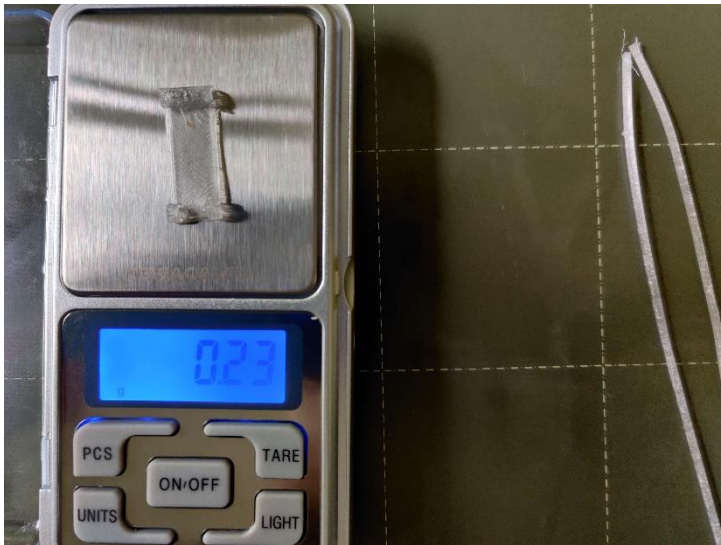
Obr. 22: Vzhled a hmotnost plošky sloužící k upevnění MSD na záda ropuch
