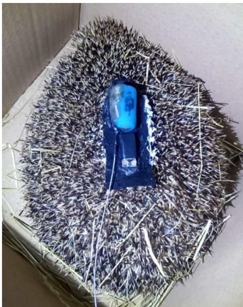
Obr. 25: Datalogger s přídatnou vysílačkou Lotek TW3
