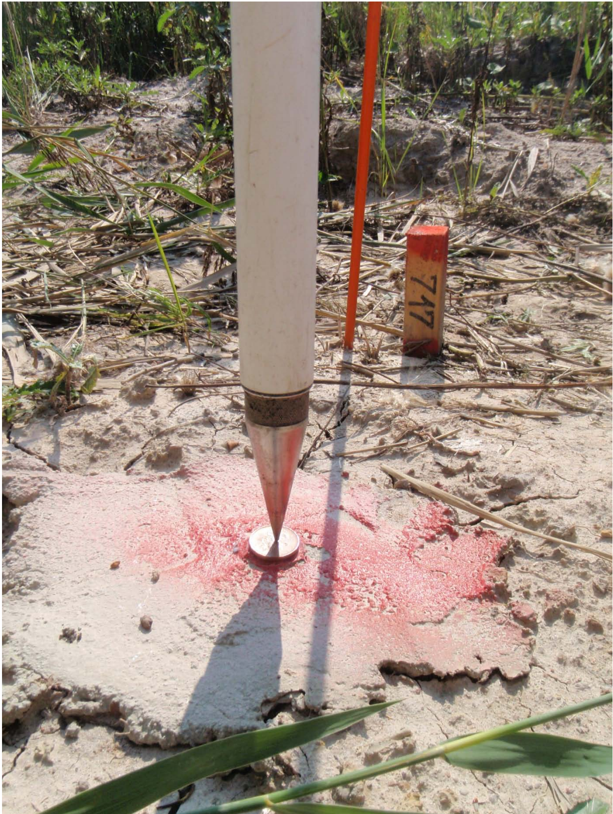
Obr. 5-2: Detailní pohled na stabilizovaný pozorovaný bod 717 s umístěnou mincí
