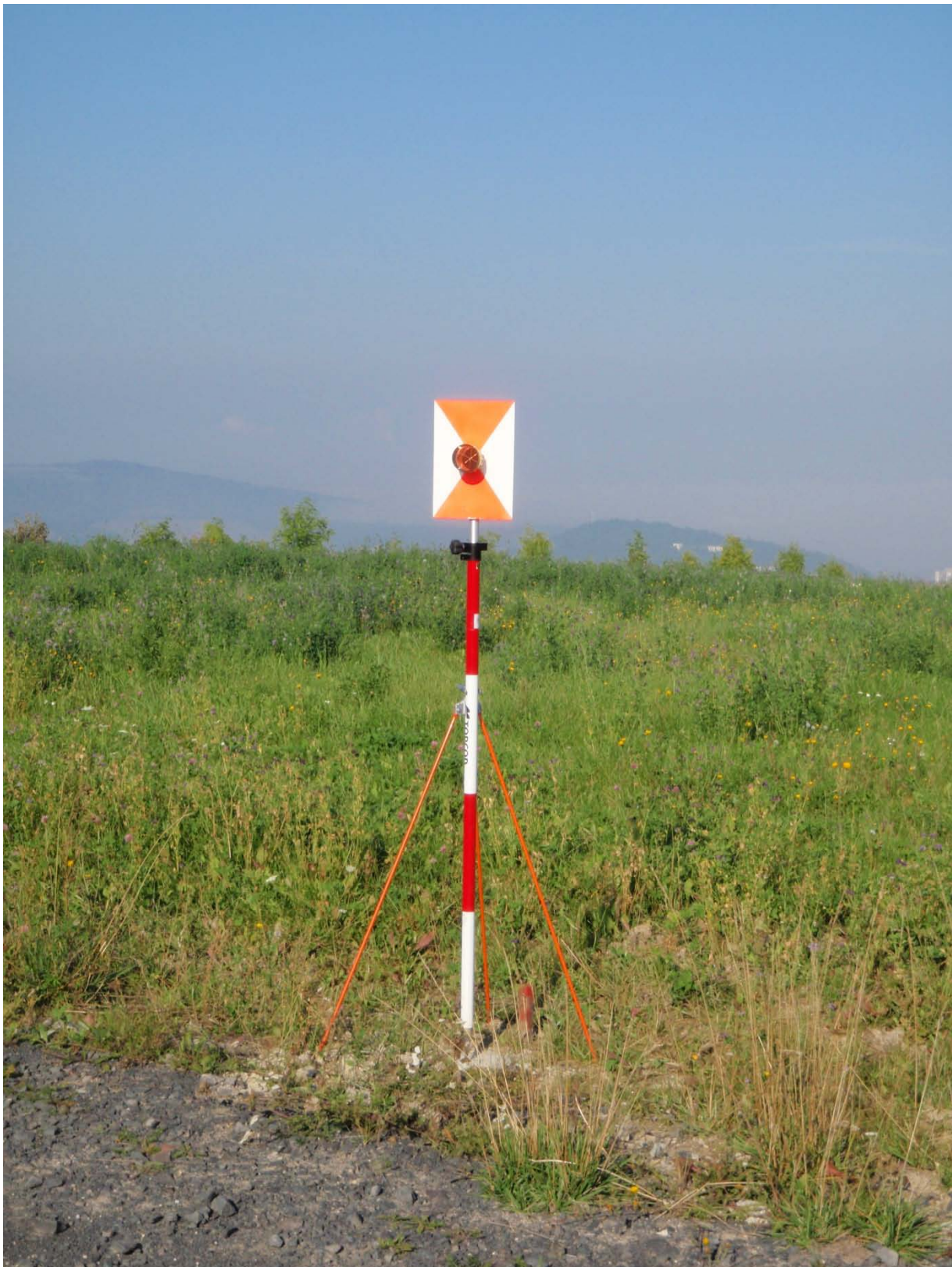
Obr. 5-3: Využití kontrastního červenobílého terče umístěného za koutový hranol
