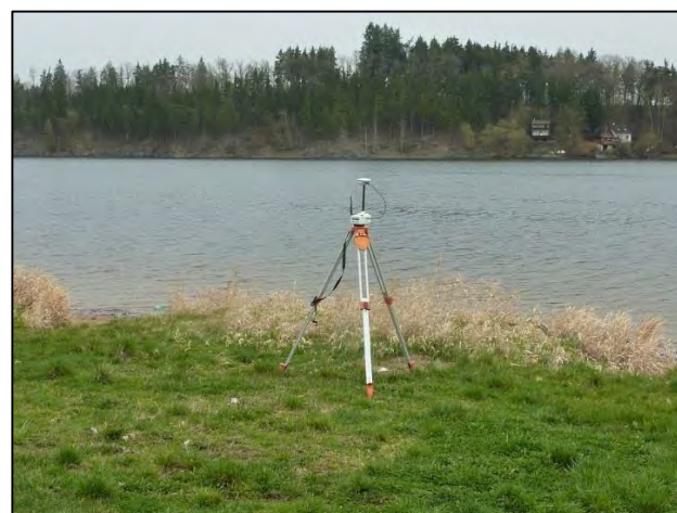
Foto č. 2: Externí stanice - konfigurace RTK
