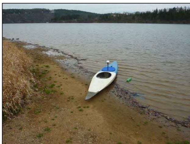
Foto č. 1: River Surveyor M9 osazený na kayaku
