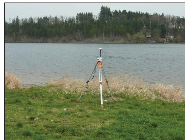
Foto č. 2: Externí stanice - konfigurace RTK
