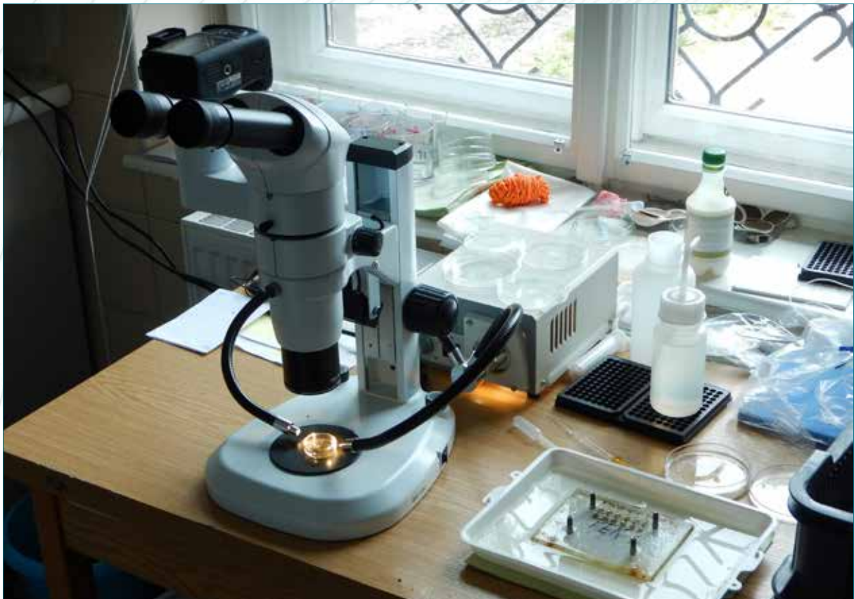
Obr. 52a. Trinokulární stereoskopická lupa s fotoaparátem pro fotografování juvenilních perlorodek.
