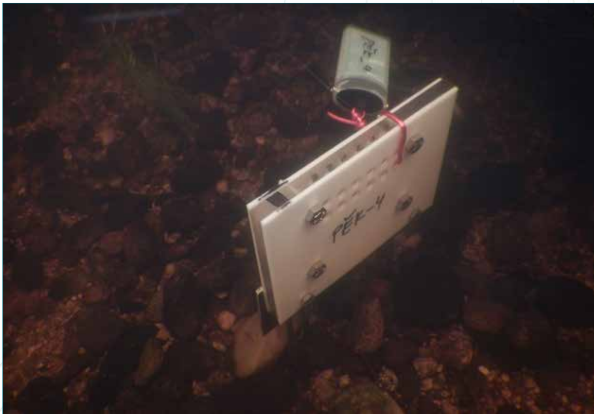
Obr. 49. Bioindikační destička nainstalovaná v terénu se záznamovým teploměrem HOBO-Pendant.
