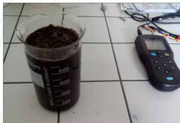
Obr. 21c. Výluh z rašelinné půdy. Vpravo konduktometr.
