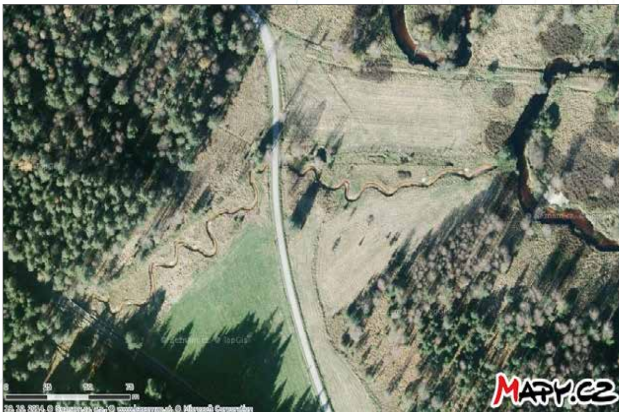
Obr. 135. Nově revitalizovaný tok Hučiny s citlivě volenou trasou meandrů v místě, kde protíná Povltavskou stezku a železniční trať Černý Kříž – Kájov. V pravé části obrázku Studená Vltava. Zdroj: Mapy.cz, © Seznam.cz, a. s., © TopGis, s. r. o.
