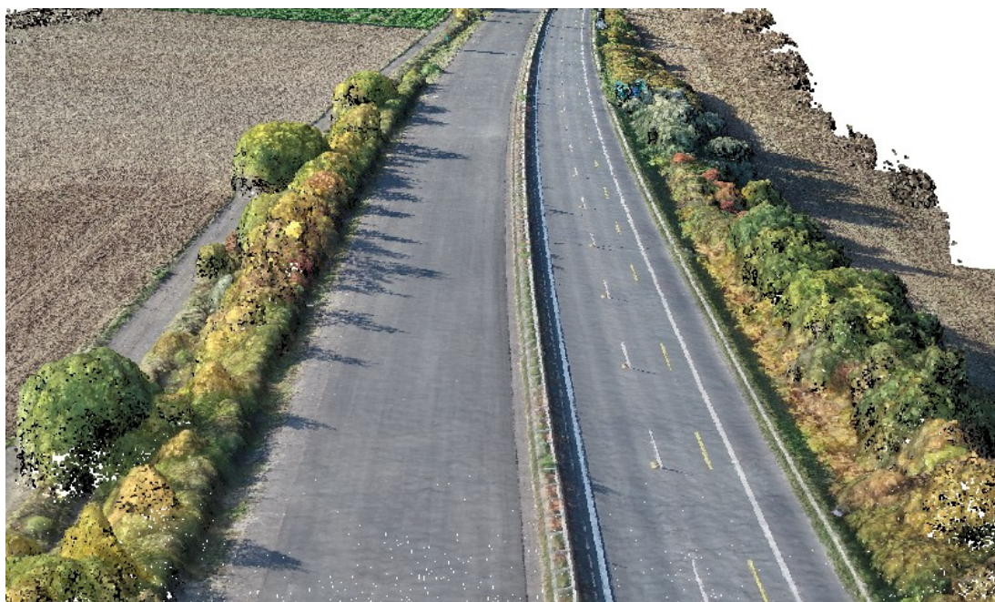
Obr. 1 Bodové mračno znázorňující rychlostní komunikaci s okolní vegetací, zdroj: vlastní
